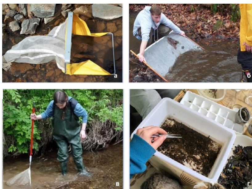
Рисунок 2. Пробоотборники и методы отбора проб беспозвоночных (а – бентометр Сарбера, б – отбор с помощью ручного экрана, в – с помощью донного сачка); г – первичная разборка проб в поле
