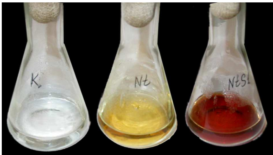
Рис. 20. Внешний вид растворов наночастиц серебра, полученных с помощью экстрактов нетрансгенной культуры табака и культуры табака, экспрессирующей ген силикатеина. Слева направо: K – раствор нитрата серебра без добавления экстракта, Nt – экстракт не трансгенной культуры с
