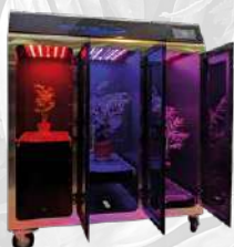
Установка ФОТОН для изучения влияния спектрального состава света на развитие растений
