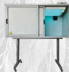
Установка для изучения влияния ультрафиолетового излучения на биологические объекты
