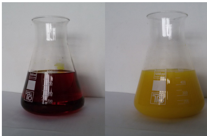
Рис. 1 Изображение раствора неразбавленного полисульфида кальция (а) и раствора после разбавления (б).
