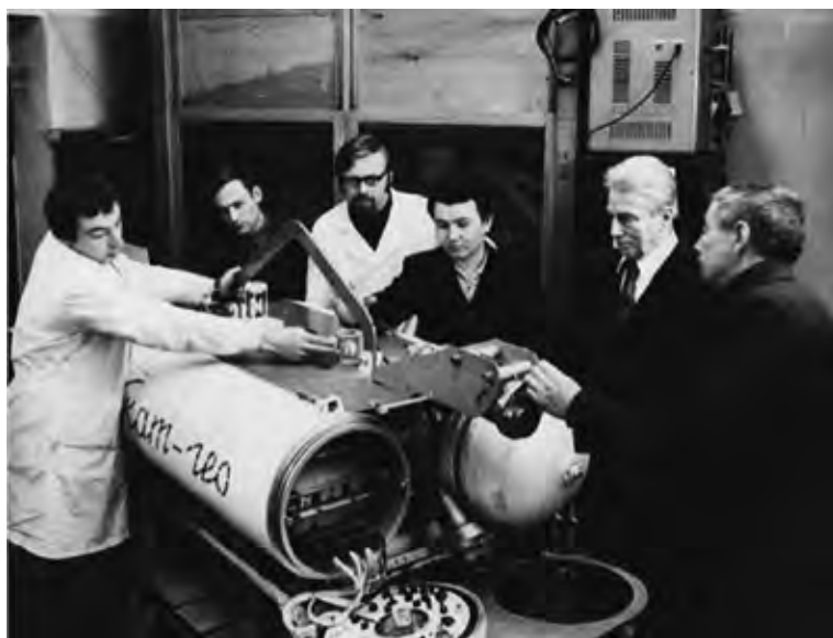
Демонстрация подводного аппарата «Скат-гео» – первого в стране экспериментального АНПА с программным управлением и гидроакустической навигацией для решения исследовательских задач на шельфе. Справа налево: д. т. н. М.Д. Агеев, академик А.А. Воронов, Ю.Г. Молоков; слева – В.В. Никифоров, 1978 г. Фото с сайта ИПМТ
