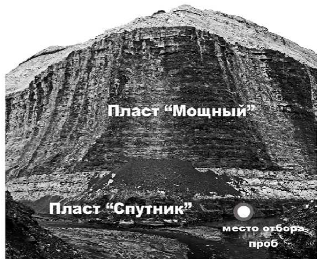
Рис. 1. Угольные пласты «Мощный» (6 м) и «Спутник» (2 м) Переясловского месторождения Канско-Ачинского бассейна Красноярского края, камалинская свита, средняя юра.
