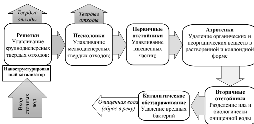
Рисунок 1 - Схема технологии очистки сточных вод
