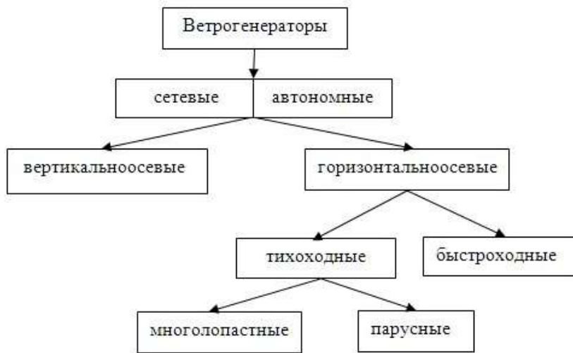
Схема – Классификация ветрогенераторов
