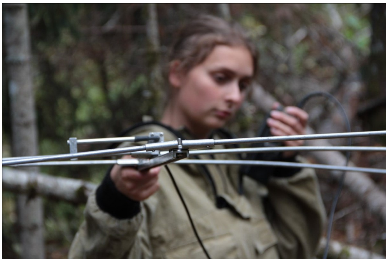
Рисунок 2.6 — Определение местоположения животного с помощью направленной антенны и радиоприемника
