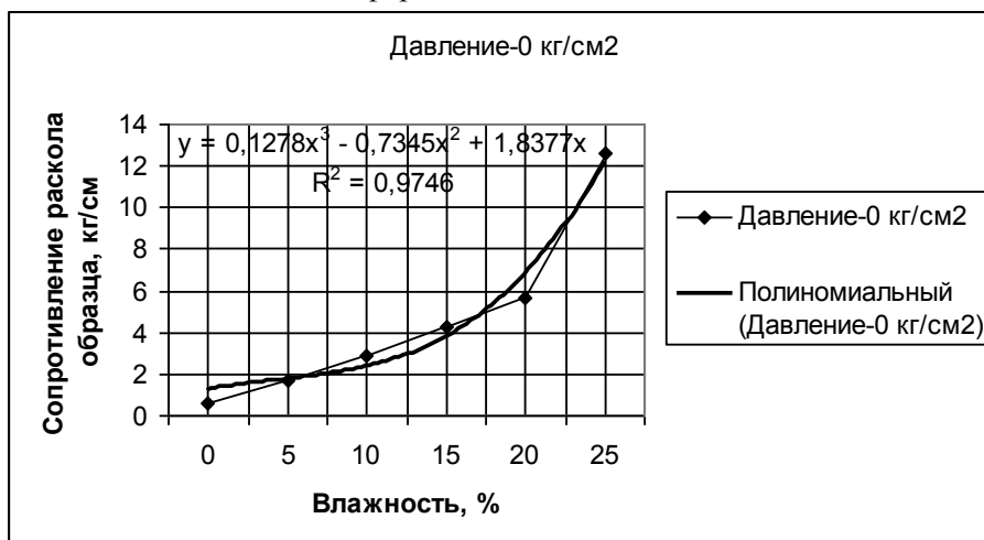
Рис.6. Зависимость предела прочности на раскол образцов из мерзлого шлама при давлении формования 0 кг/см 2
