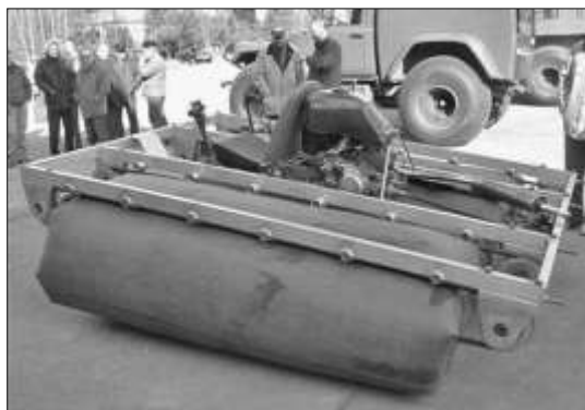
Рис. 8. Ходовые испытания экспериментального самоходного макета снего-болотохода с тороидным пневмодвижителем
