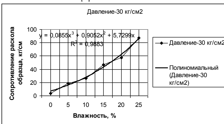
Рис.2. Зависимость предела прочности на раскол образцов из мерзлого шлама при давлении формования 30 кг/см 2
