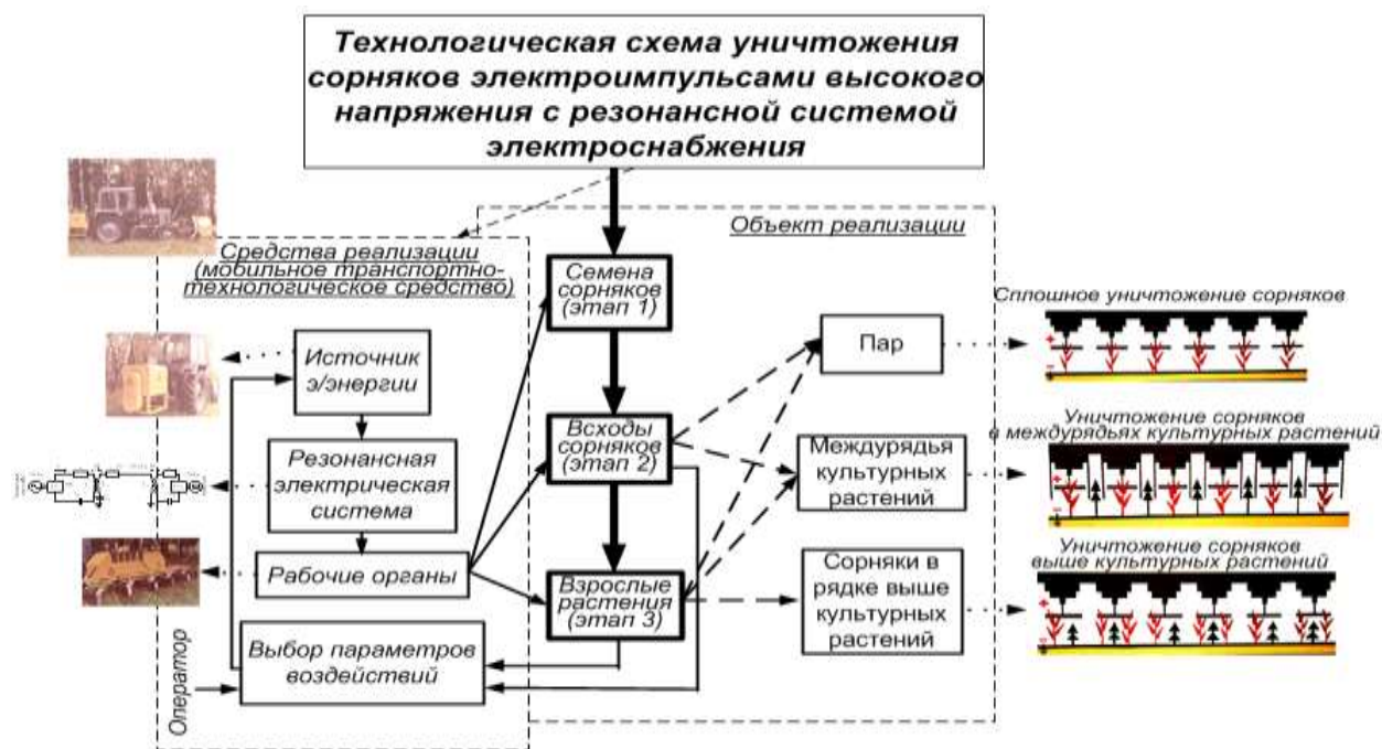
Рис. 5 Технологическая схема уничтожения сорняков электрическими методами
