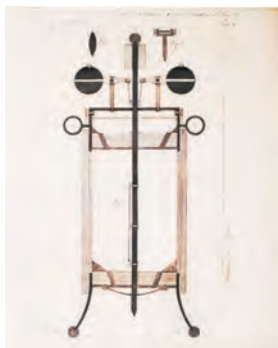
Барометр Ленца и Паррота. Из: [Lenz, 1831, tab. I.]
