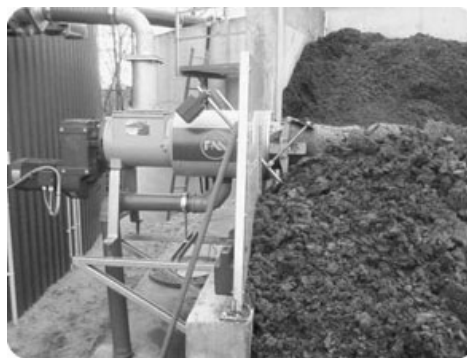
Рис. 20.6. Сепаратор для разделения массы биоудобрения
