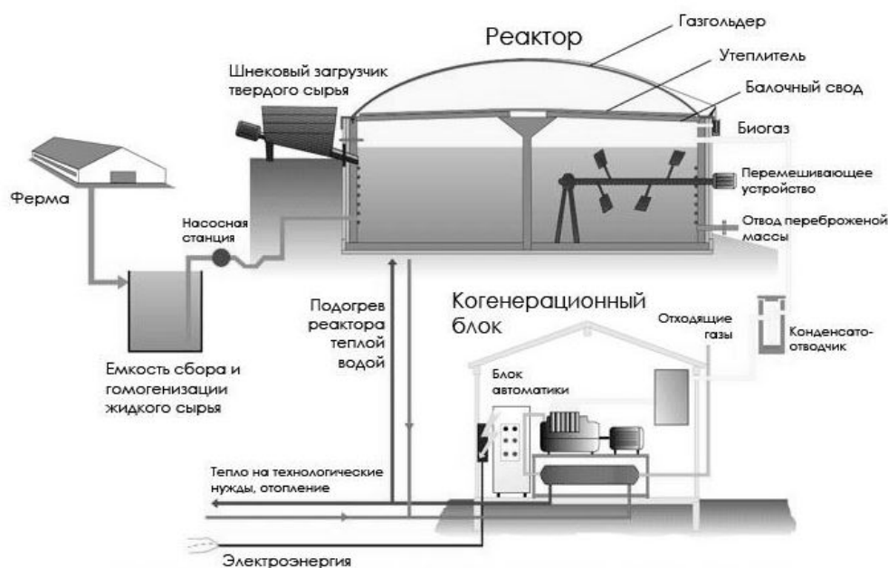
Рис. 20.9. Технологическая схема БГУ
