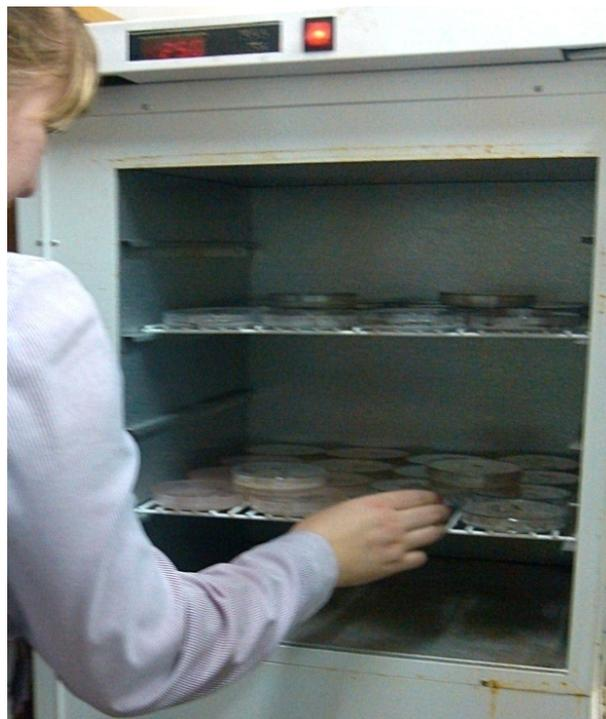
Рисунок 2 – Термостат ТС-80 «КЗМА»
